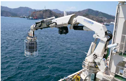
東北海洋生態系調査船 (学術研究船)「新青丸」でのCTD観測調査 CTD measurement on board R/V Shinsei Maru
