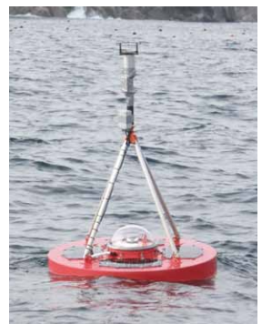
大槌湾の風と波浪のリアルタイムモニタリング Real-time monitoring of wind and wave in Otsuchi Bay
