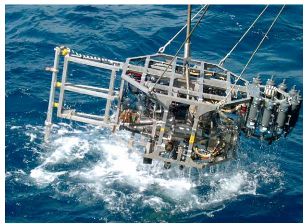
自航式深海底サンプル採取システム Navigable Sampling System (NSS)
