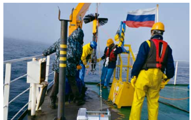
ロシア船における乱流計回収作業風景 Recovery of turbulent microstructure profiler on deck of Russian vessel
