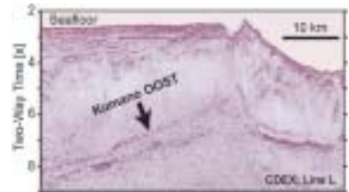
Fig.2 熊野沖反射断面図上で確認される地震性分岐断層
