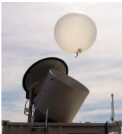
GPSゾンデの放球 Launching of GPS sonde
