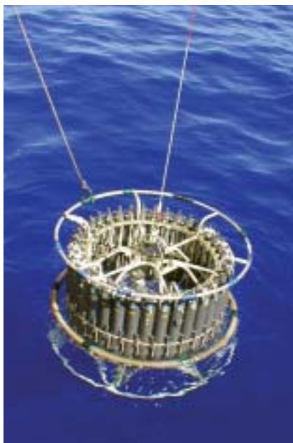
CTD-CMSシステムを用いたクリーン採水 Clean seawater sampling using CTD-CMS system
