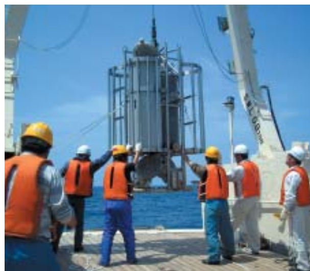
研究船淡青丸における大量採水器を用いた観測作業（日本海にて） Large volume water sampling on board R/V Tansei-maru (Japan Sea)
