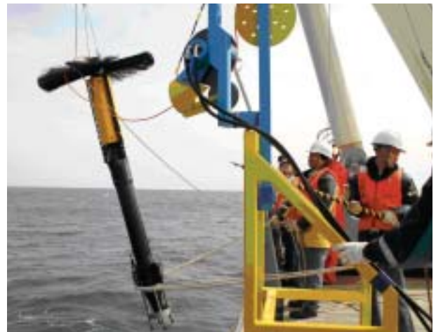
2000m深までの鉛直乱流拡散を有線で連続的に計測する Real-time vertical eddy diffusivity measurement down to 2000m depth
